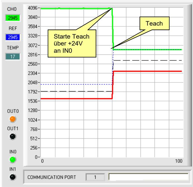
Nach einem positiven Signal (+24V) am Eingang IN0 wird die Sendeleistung so eingestellt, dass sich der Sensor im Dynamikbereich, welcher mit **DYN WIN LO** und **DYN WIN HI** eingestellt wird, befindet. Der aktuelle **CH0** Wert wird zur neuen Referenz **REF**.
