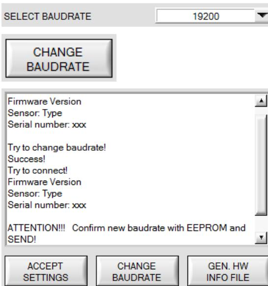
Unter **SELECT BAUDRATE** kann jetzt eine neue Baudrate ausgewählt werden. Durch Drücken von **CHANGE BAUDRATE** wird die neue Baudrate zum Sensor übertragen.
