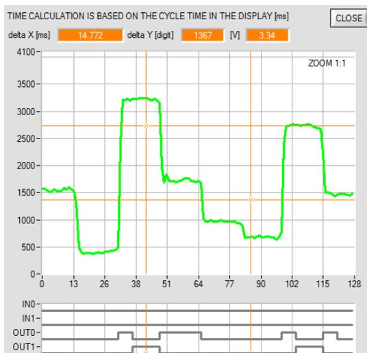
Durch Halten Steuerungstaste Strg (CTRL) und Aufziehen eines Fensters mit der Maus im Graphen kann in den Graphen gezoomt werden.
